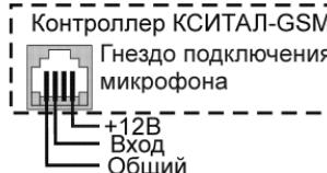
При необходимости к входу этого микрофона может быть подключен еще один микрофон "Кситал-МК". В такой цепочке допускается соединять до 3 шт. микрофонов "Кситал-МК", которые будут работать одновременно.
