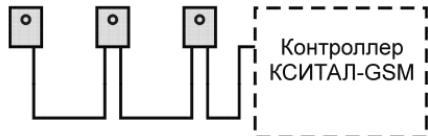
Для подключения микрофона "Кситал-МК" его выход просто соединяется с входом контроллера 10-метровым шнуром, входящим в комплект микрофона.
