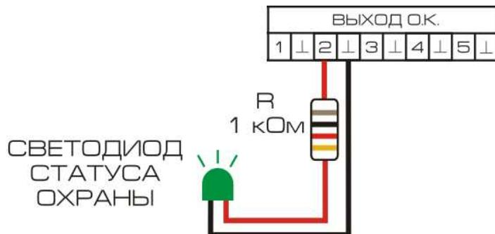
Подключите светодиод (лампу) в соответствии со схемой, представленной выше. При этом соблюдайте полярность.
