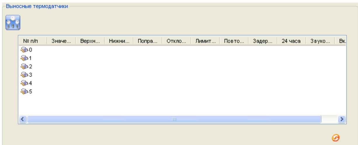
Данный пункт меню отображает настройки всех подключаемых температурных датчиков. Подключаемые датчики поддерживают измерения температуры в диапазоне -55...+125 и должны быть типа «DS18B20». Для внесения изменений в настройки датчиков необходимо произвести двойное нажатие ЛКМ на строчке с номером термодатчика и в открывшемся окне произвести изменения.
