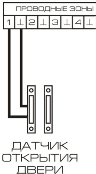
К пассивным датчикам относятся датчики которые не имеют в своем составе каких-либо электронных схем, а имеют как правило только 2 контакта. Пассивные датчики не требуют подключения питания и подключаются непосредственно к колодкам контрольной панели. При этом
