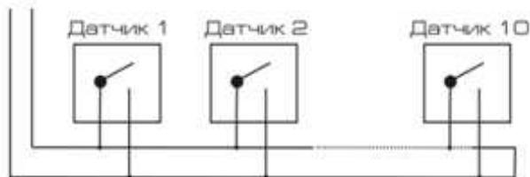
Датчики, имеющие выходной контакт типа «Нормально замкнутый контакт» («NC»), соединяются друг с другом последовательно.
